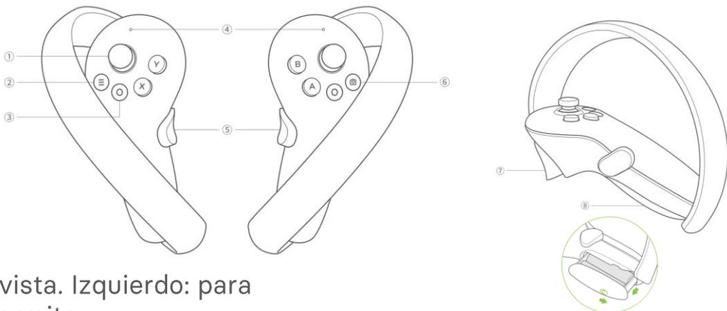
1. Joystick. Derecho: para girar la vista. Izquierdo: para desplazarse si la aplicación lo permite.
